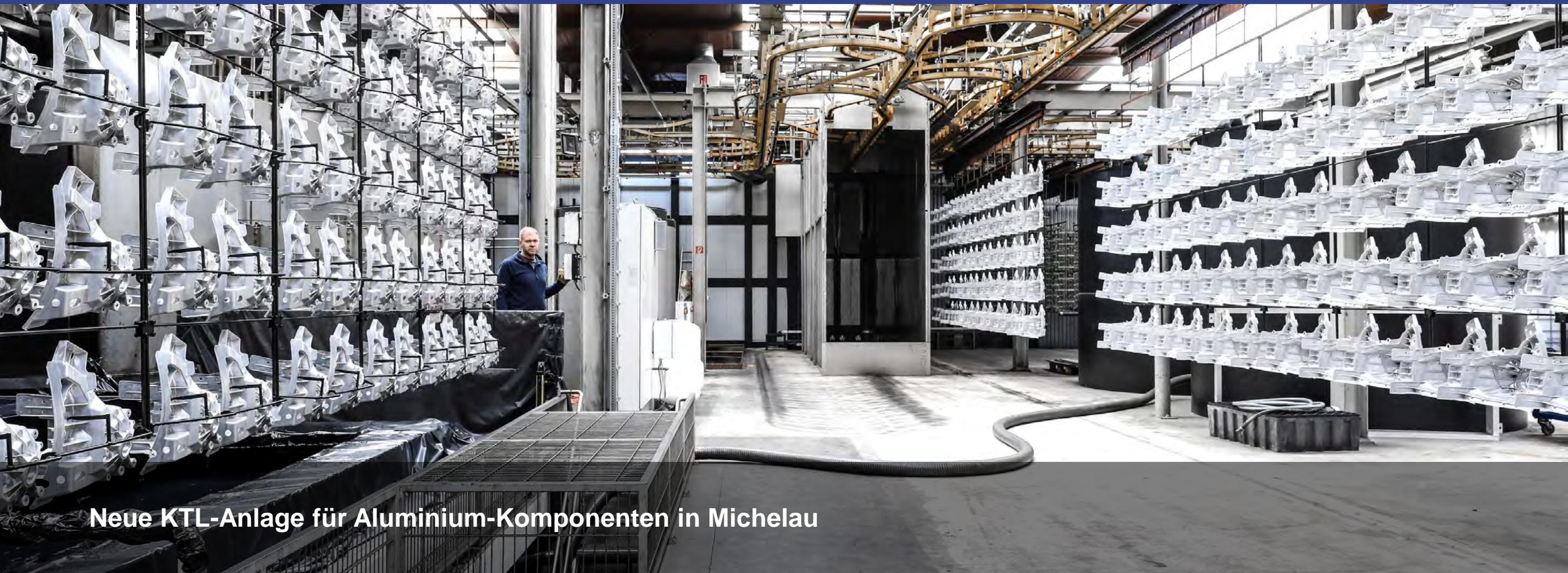
**Neue KTL-Anlage für Aluminium-Komponenten in Michelau**
