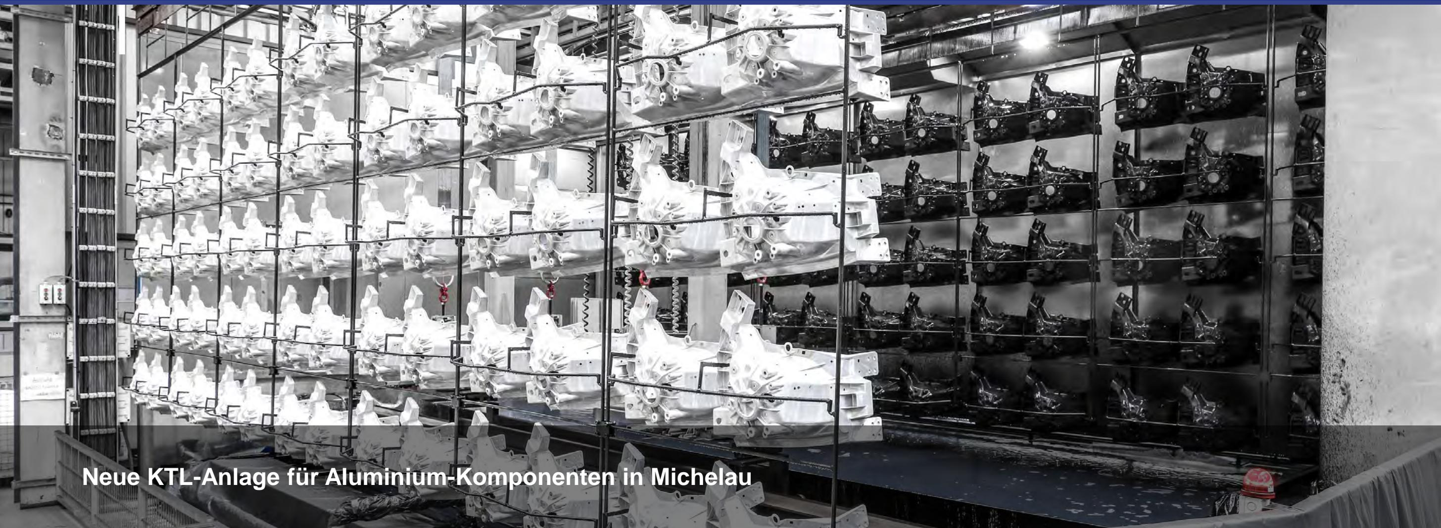
Neue KTL-Anlage für Aluminium-Komponenten in Michelau
