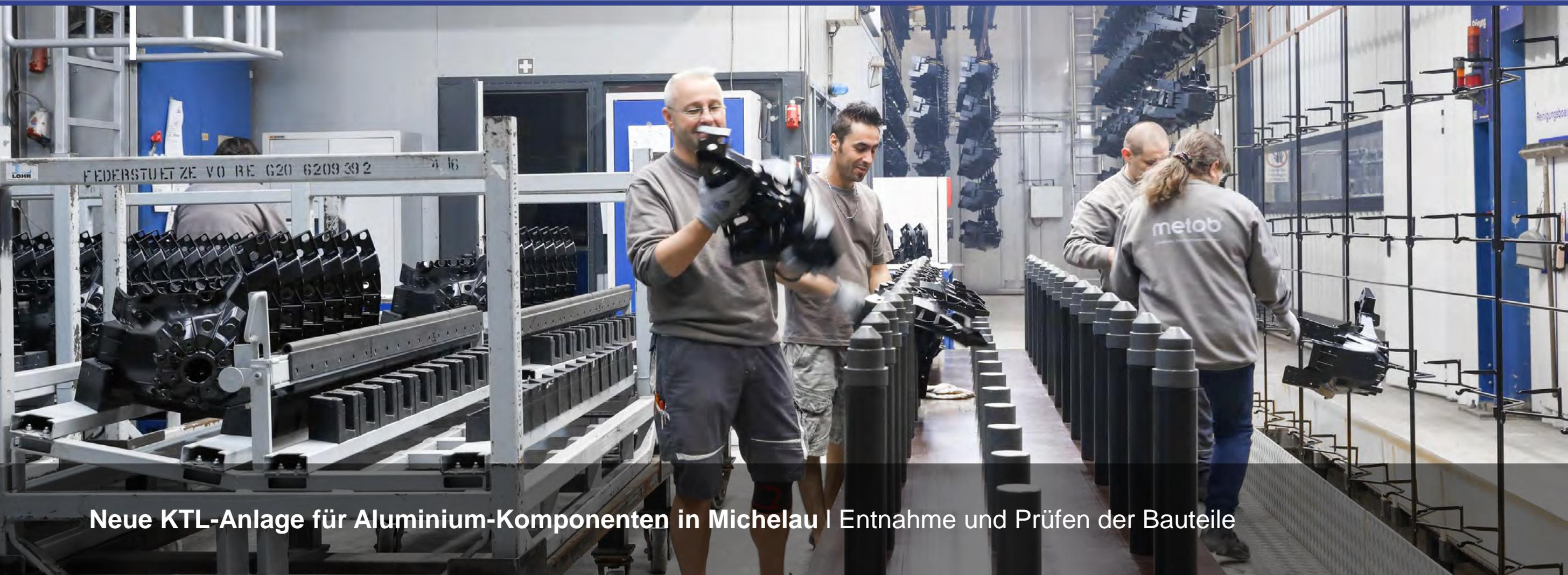
Neue KTL-Anlage für Aluminium-Komponenten in Michelau | Entnahme und Prüfen der Bauteile
